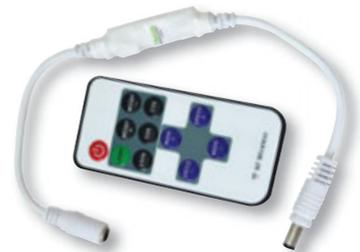
Le strisce LED preprogrammate sono capaci di visualizzare differenti giochi di luce con l'aiuto dell'unità di controllo **LED-RF**. I controlli devono essere inseriti al circuito 12-24 VDC dell'alimentatore accuratamente scelto, tra il nastro e l'alimentatore. Il **LED-RF-1** può essere comandato tramite la tastiera integrata, mentre la versione **LED-RF-2** utilizza un telecomando a radiofrequenza.
