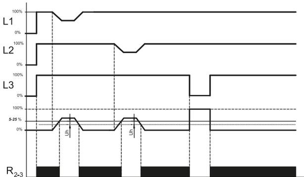
Progettato per proteggere motori trifase da sovratensione e da surriscaldamento. L'utente può regolare il livello di sovratensione con un potenziometro.
