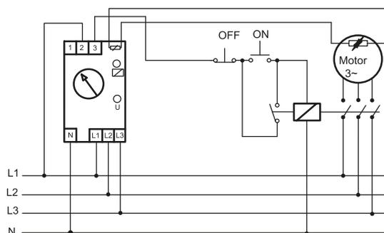
Termistore PTC per il relè di monitoraggio tensione con protezione termica
