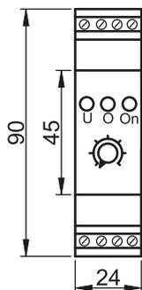
Questo microcontrollore è basato su relè di protezione contro sovra - e sottotensione. È progettato per circuiti trifase ma può essere utilizzato anche nei circuiti monofase. Rileva la tensione in ogni fase e commuta il relè in caso di necessità.
