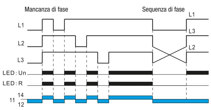
**Diagramma di funzionamento di errore fasi e ordine fasi**
