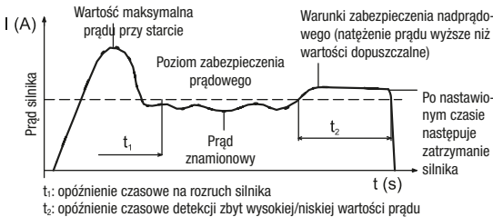
Zasada działania przełącznika TFKV-AKA05
