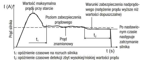
Zasada działania przełącznika TFKV-AKD05
